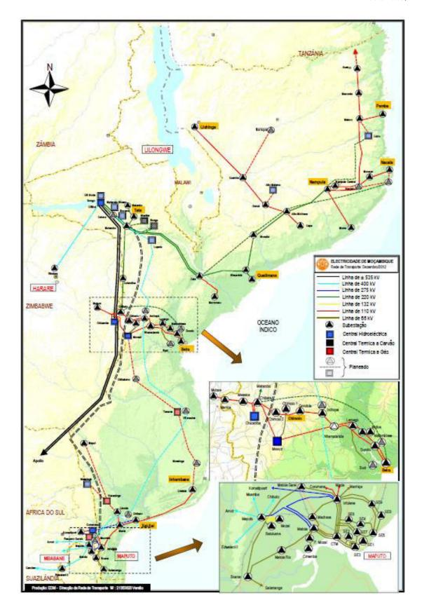
Figura 5.2 – Rede Nacional de Transporte de Energia (Fonte: EDM -s/e)
